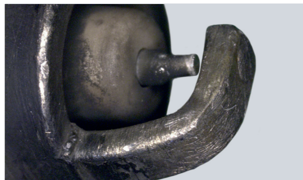
Elektroden beschadigd door reiniging met een staalborstel
