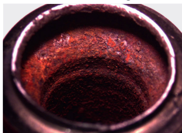
Corrosie binnenin de bougie, veroorzaakt door gebrek aan gasdichtheid.
