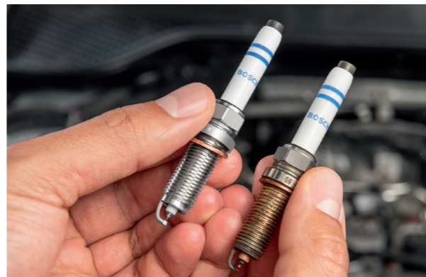
Vergelijking van een gebruikte en een nieuwe bougie
