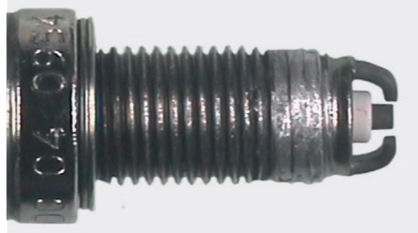
Gesmolten aluminium van de cilinderkop in de stalen schroefdraad van de bougie
